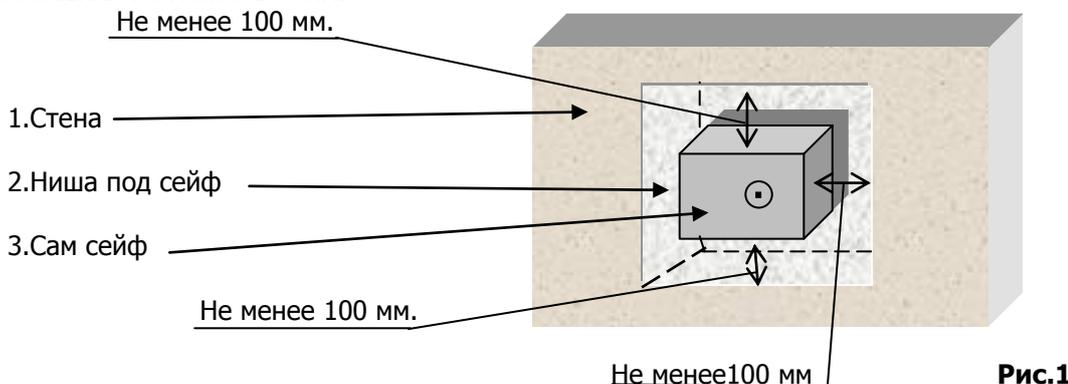
2. Сейф вставляется в подготовленную нишу, выравнивается и закрепляется, например, с помощью клиньев. Положение сейфа проверяется по уровню. Дверь сейфа не должна самопроизвольно ни закрываться, ни открываться.
